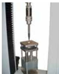
Приспособление для испытания на прокол материал: резина, бумага, пластик, геотекстиль, текстиль С большим выбором прокалывающих устройств и отверстий под прокол.
