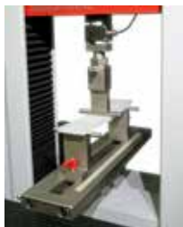
Зажимы на 3-х точечный изгиб Макс. нагрузка 25 кН Расстояние базы: 5-25; 10-100; 50-300; 50-500; 300-600 мм
