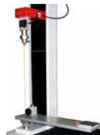
Приспособление для определения коэффициента трения Масса салазок 200 или 400 г Макс. размер образца 100x300 мм
