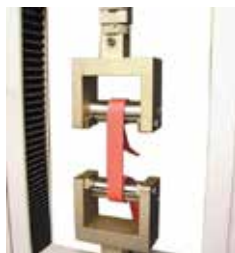
Раздельные самозатягивающиеся роликовые зажимы для ремней Макс. нагрузка 200 кН Макс. ширина образца 200 мм Материал: ремни, ленты, геотекстиль
