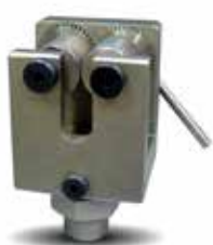
Роликовые зажимы с двойным эксцентриком Макс. нагрузка 5 и 10 кН Макс. размер образца 28x8 и 25x10
