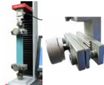
Волнистые зажимы для ткани поролона Макс. нагрузка 2,5 кН Ширина образца до 150 мм Толщина образца 5 мм
