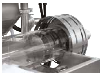
Фланец с тепловым экраном (пакет для газации 15)
