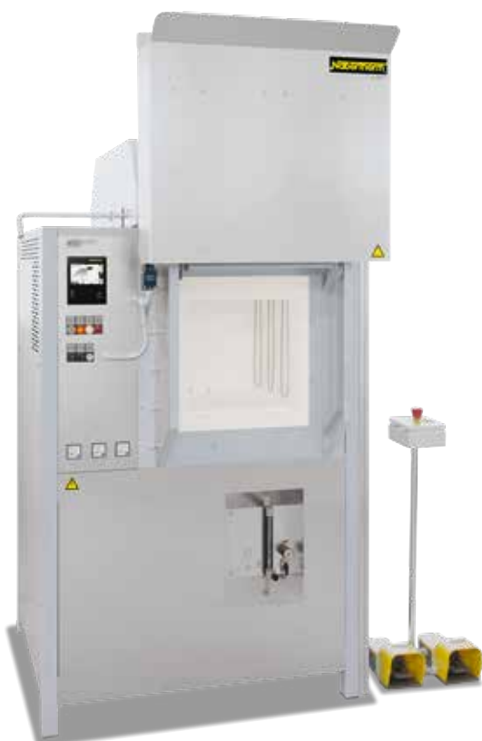
Высокотемпературные печи HT 64/16S с подъемной дверцей
