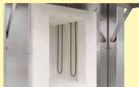
Высококачественные нагревательные элементы из дисилицида молибдена
