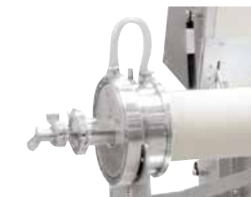
Водоохлаждаемый вакуумный фланец (пакет для газации 2)
