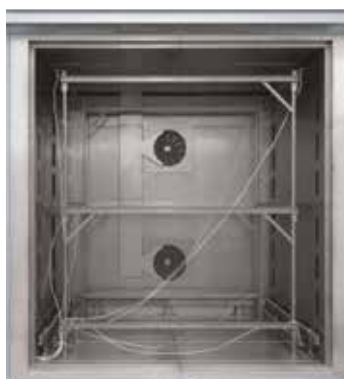
Съемная мерная стойка для конвекционной камерной печи N 7920/45 HAS
