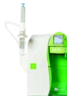
**Direct-Q 3 UV (Millipore).** Настольная система для получения двух типов воды из одной установки и непосредственно от водопровода: общелабораторного назначения (тип III, 3л/час) и высокоочищенной воды реагентного качества (тип I, более 18 МОм\*см, 0,5л/мин).
