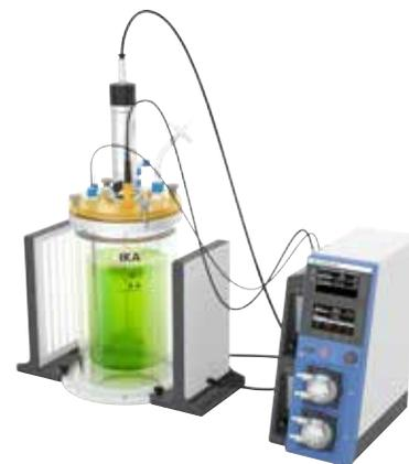
Крышка биореактора выполнена из автоклавируемого термопластика Ultem®.
